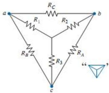
$$R_A = \frac{R_1 R_2 + R_1 R_3 + R_2 R_3}{R_1}$$
